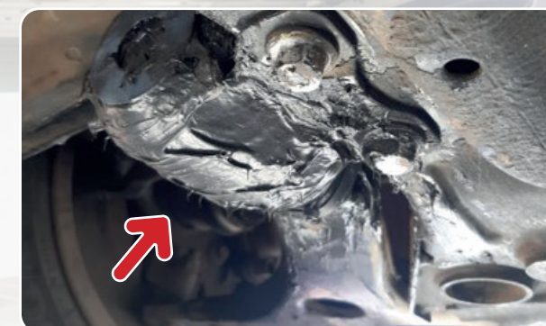
EJES, RUEDAS, NEUMÁTICOS Y SUSPENSIÓN Brazo suspensión sujeta con masilla adhesiva
