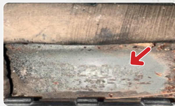
IDENTIFICACIÓN Nº de bastidor oxidado. Ilegible
