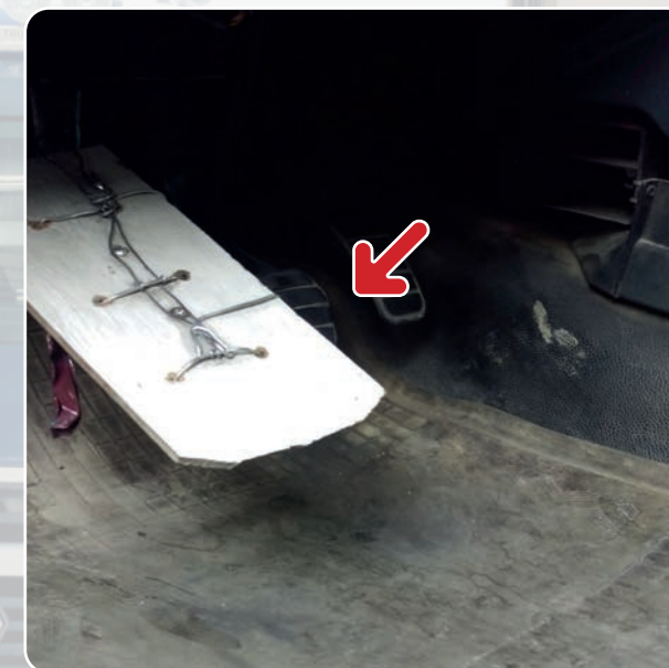
ACONDICIONAMIENTO INTERIOR Pedal embrague transformado
