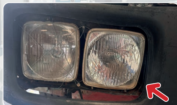
ALUMBRADO Y SEÑALIZACIÓN Focos sujetos con alambres
